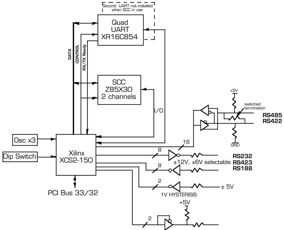
FIGURE 1 PMC-SERIAL BLOCK DIAGRAM
