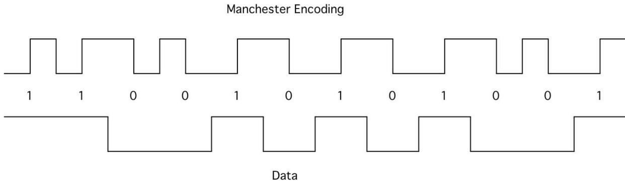
FIGURE 3 PMC-BISERIAL-III MDS1 - DATA ENCODING
