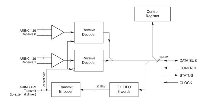
FIGURE 1. DD-03282 BLOCK DIAGRAM
