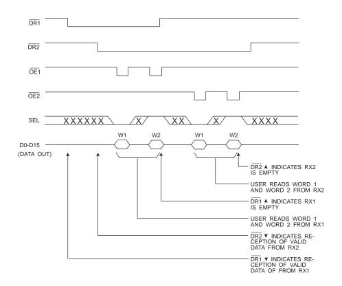
FIGURE 8. TYPICAL RECEIVER READ SEQUENCE
